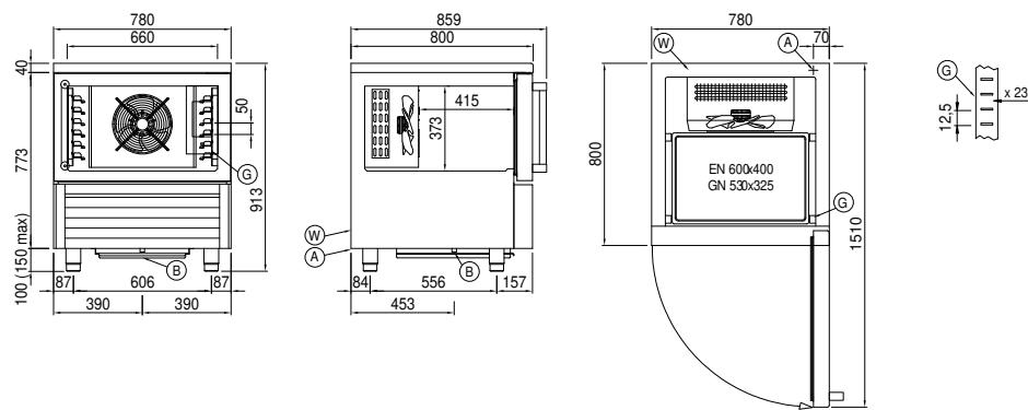
A: Alimentación del cable de salida
