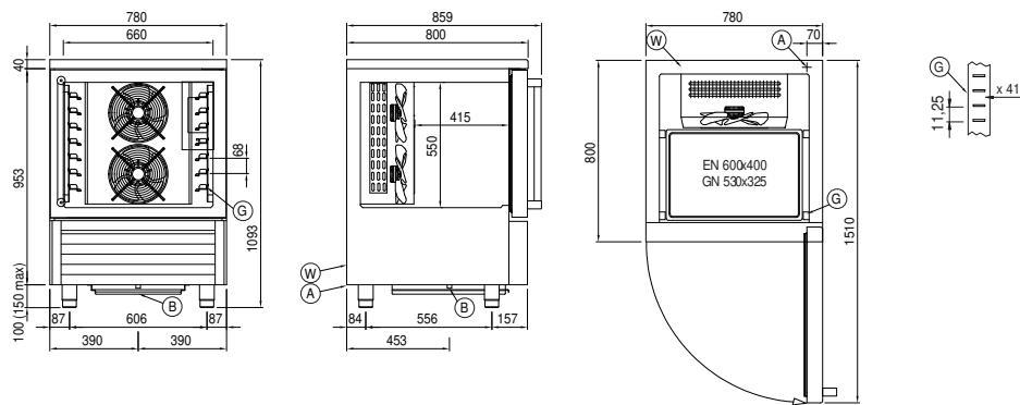
A: Alimentación del cable de salida
