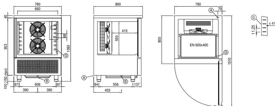
**A:** Alimentación del cable de salida
