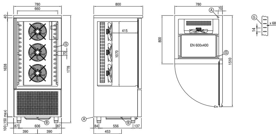
A: Alimentación del cable de salida      B: Descarga del agua de condensación      G: Cremalleras
