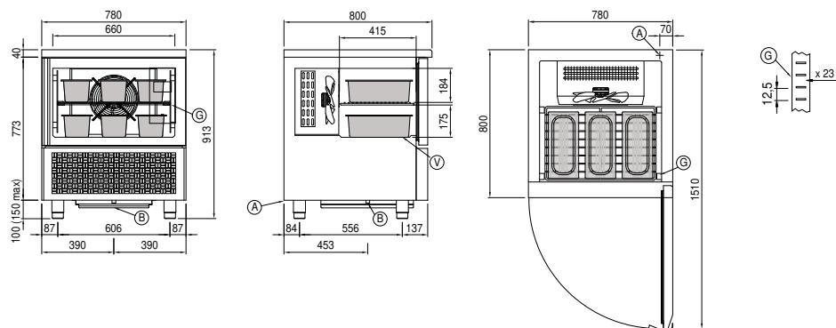
A: Alimentación del cable de salida
