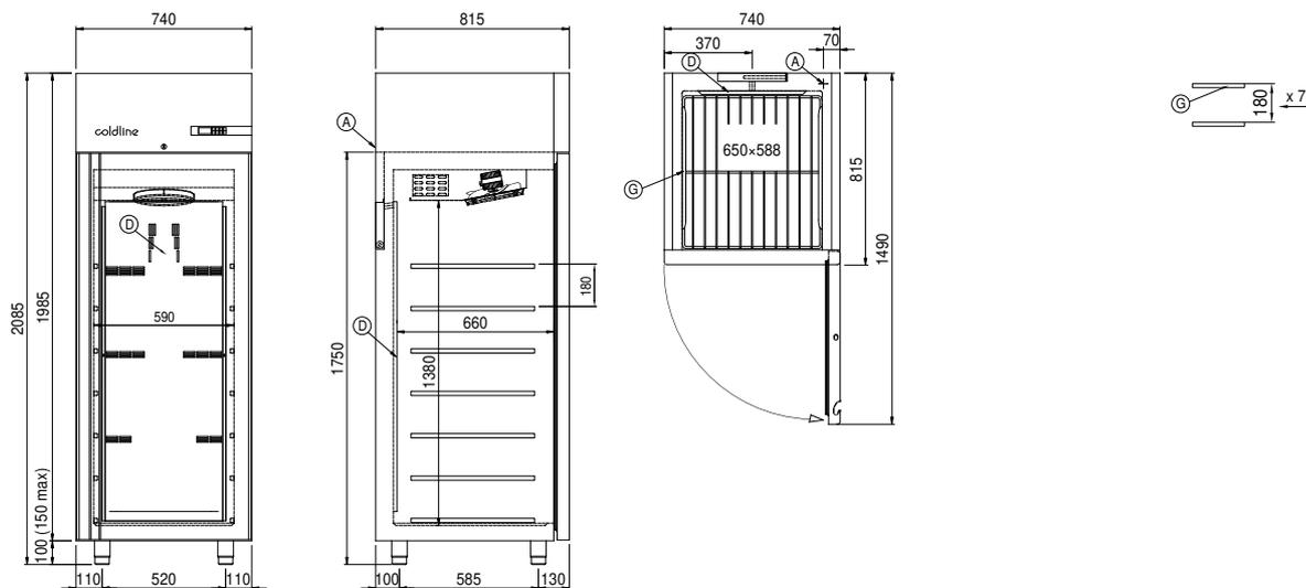
**A:** Alimentación del cable de salida
