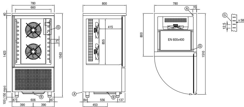
**A:** Alimentación del cable de salida      **B:** Descarga del agua de condensación      **G:** Cremalleras
