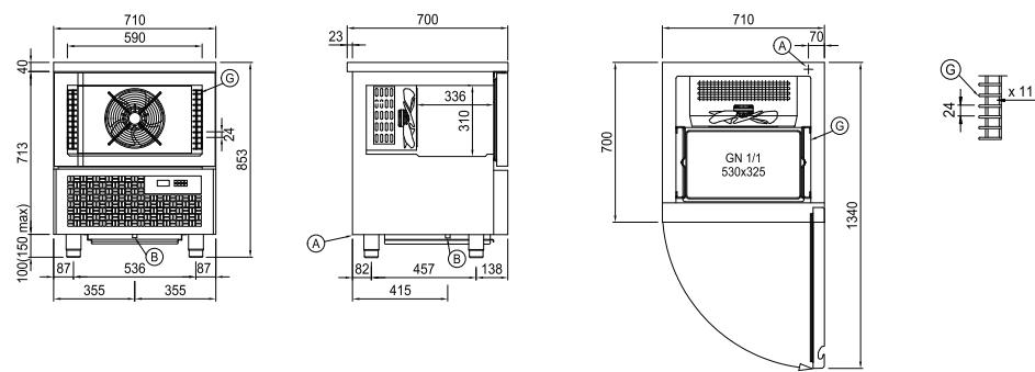
**A:** Выход кабеля питания**B:** Слив конденсата**G:** Направляющие и стойки
