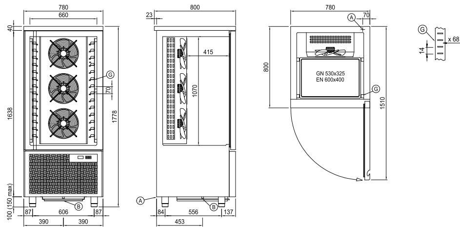
**A:** Выход кабеля питания**B:** Слив конденсата**G:** Направляющие и стойки
