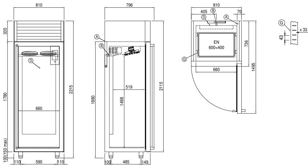
A: Alimentación del cable de salida
