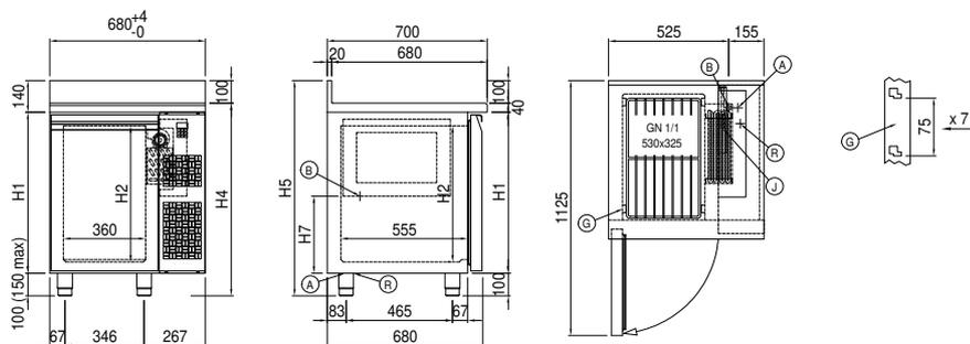
A: Uscita cavo alimentazione      B: Scarico condensa      G: Cremagliere
