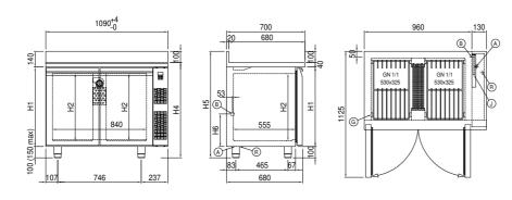
A: Uscita cavo alimentazione B: Scarico condensa G: Cremagliere
