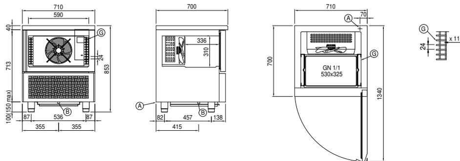
A: Alimentación del cable de salida      B: Descarga del agua de condensación      G: Cremalleras
