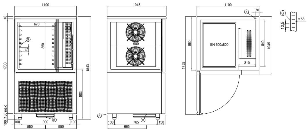
A: Alimentación del cable de salida
