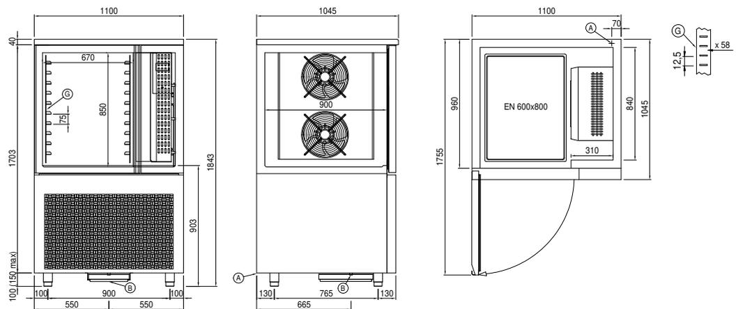
A: Alimentación del cable de salida      B: Descarga del agua de condensación      G: Cremalleras
