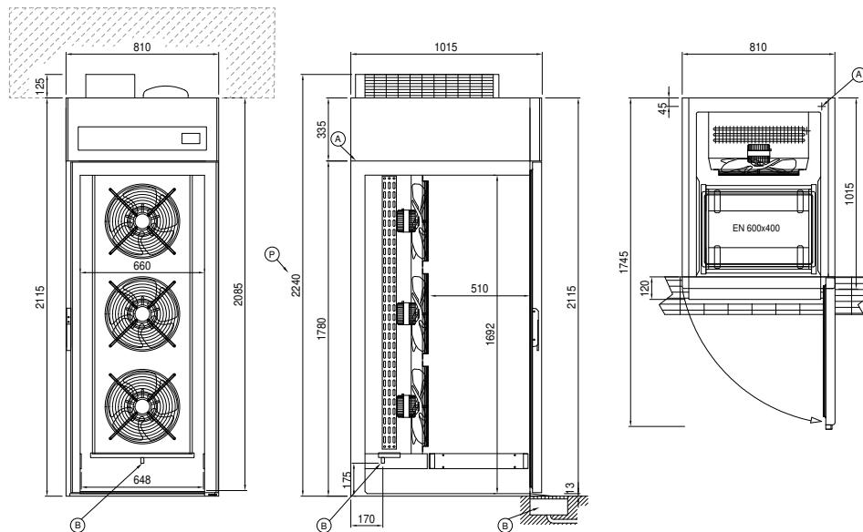
A: Alimentación del cable de salida
