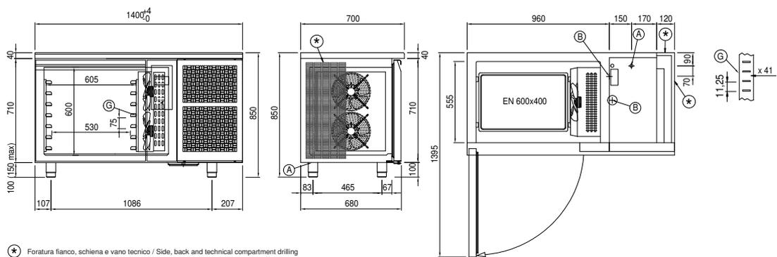
A: Alimentación del cable de salida      B: Descarga del agua de condensación      G: Cremalleras
