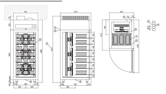
A: Alimentación del cable de salida B: Descarga del agua de condensación G:
