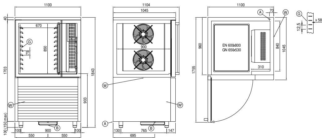
A: Alimentación del cable de salida
