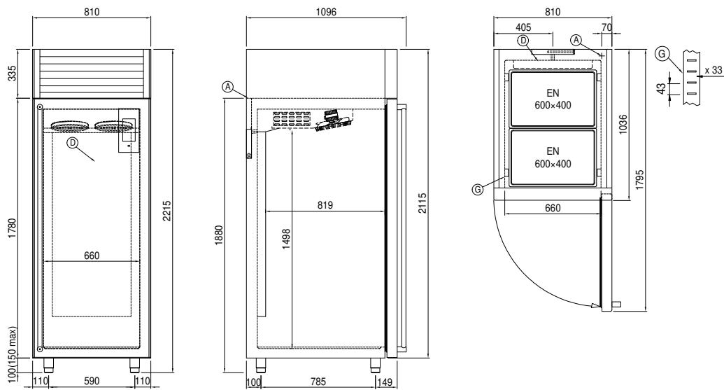
A: Alimentación del cable de salida
