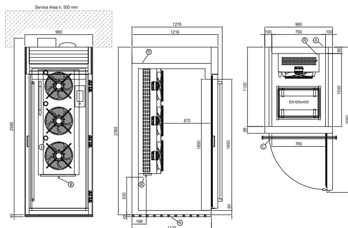
**A:** Выход кабеля питания**B:** Слив конденсата**I:** Внутреннее светодиодное освещение**R:** Выход трубок фреона
