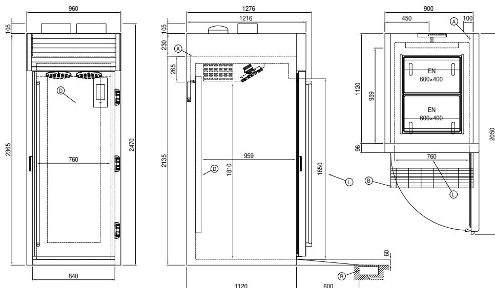
A: Alimentación del cable de salida      B: Descarga del agua de condensación      D: Difusor flujo de aire
